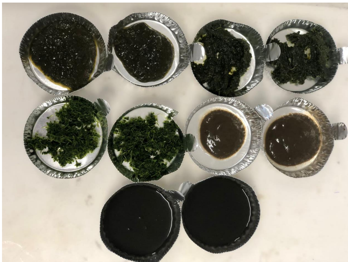
Zdjęcie nr 3. Naważone próbki samego bartszczu, w proporcji 20 i 50 % z osadem ściekowym, oraz próby inokulum.
