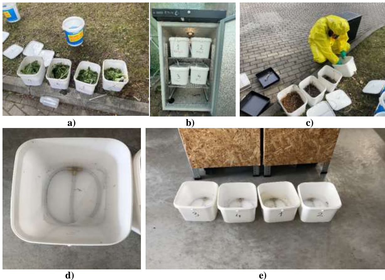
Rys. 3.2. Widok na stanowisko badawcze kompostowania Heracleum sp, a) reaktory napelnione materialem przed wymieszaniem, b) reaktory do kompostowania w szafie termostaticznej, c) widok na stanowisko do pobierania próbek w trakcie procesu kompostowania, d) wewnątrz reaktora z kanałem napowietrzającym, e) reaktory przed rozpoczęciem procesu kompostowania
